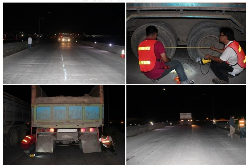
รูปที่ 3.19 การทดสอบโดยใช้รถบรรทุกสลับเคลื่อนผ่านช่วงสะพานที่ทำการทดสอบ
