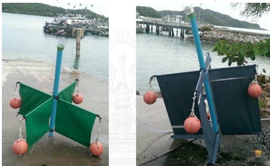
รูปที่ 8 ลักษณะทุ่นลอยที่ใช้ติดตามกระแสน้ำ โดยมีความยาว 50 เซนติเมตร (ซ้าย) และ 90 เซนติเมตร (ขวา)
