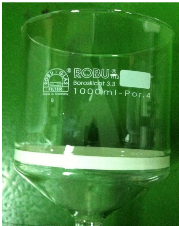
รูปที่ 3. 13 ฟิวเตอร์ฟูลเนล เบอร์ 4 ขนาดรุกรอง 10-16 ไมโครเมตร
