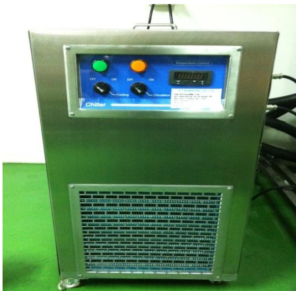
รูปที่ 3. 4 ชุดเครื่องระบบสารหล่อเย็น Chiller
