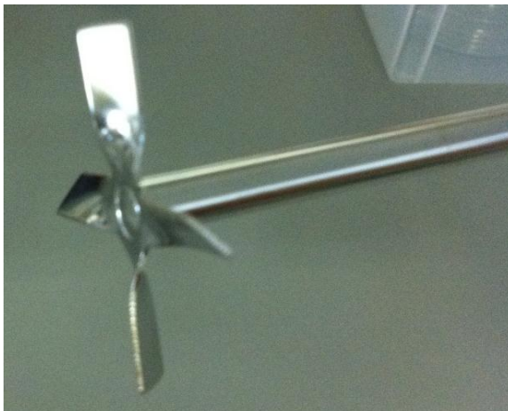
รูปที่ 3. 7 ใบกวนชนิดพิซ เบลด จำนวน 4 เบลด สำหรับเครื่องปฏิกรณ์ 2 ลิตร
