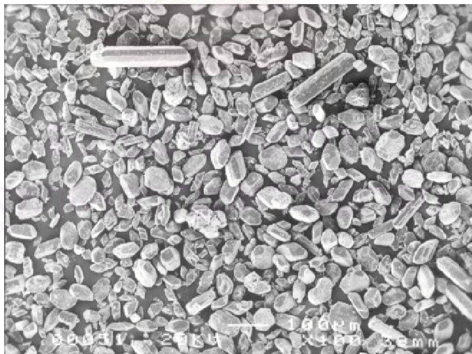
รูปที่ 2-5 ภาพถ่าย SEM ของยิปซัมฟลูแก๊สที่ผ่านการล้างแล้ว 4
