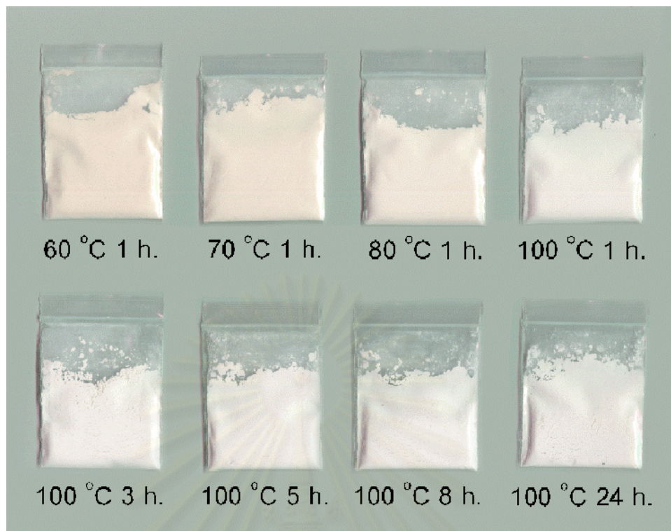
รูปที่ 4-20 แสดงลักษณะของสารที่ได้จากการอบยิปซัมฟลูแก๊สผสมกรดซัลฟูริก
