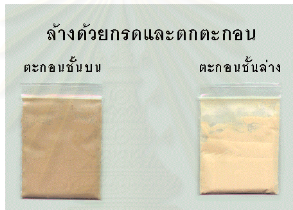
รูปที่ 4-14 แสดงลักษณะของยิปซัมฟลูแก๊สที่ล้างโดยการชะด้วยกรดและตกตะกอน
