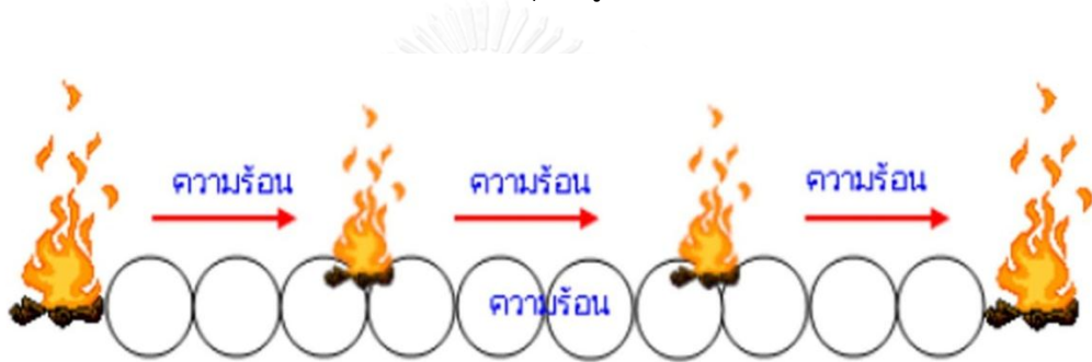
ภาพที่ 10 แสดงการถ่ายเทความร้อนโดยวิธีการนำความร้อน
