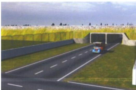
รูปที่ 6.4 ทางลอด (Underpass ) และทางลอดท่อคอนกรีตเหลี่ยม (Box culvert)
