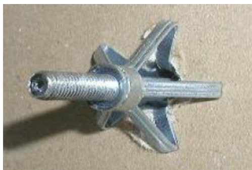
ภาพที่ 4.7 ภาพด้านหลังของพุกยึดเข็มเหล็กแบบรุ่ม เมื่อไขจนแน่น [35]
