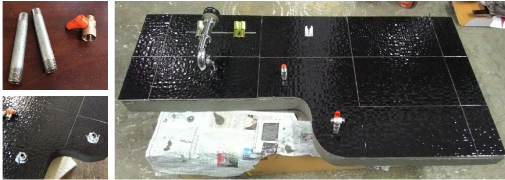
ภาพที่ 3.14 ท่อเหล็กกึ่งเกลียวและตำแหน่งติดตั้งบนชิ้นงาน ของอุปกรณ์ประกอบ
