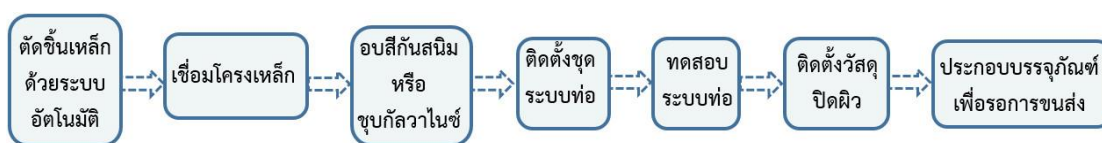
ภาพที่ 5.3 ข้อเสนอแนะขั้นตอนการผลิตในระบบอุตสาหกรรม โดยผลิตสำเร็จเป็นชุดเดียวและนำไปติดตั้งในพื้นที่ก่อสร้าง
