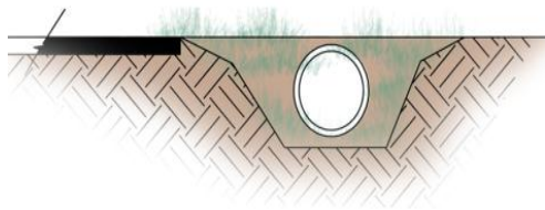
c. รูปแบบวางระบายน้ำดิน
