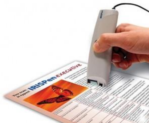
ภาพที่ 11 แสดงเครื่องอ่านอักขระด้วยแสง (OCR)
