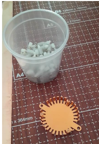
ภาพที่ 20 แสดงภาพ Aluminum heat sink จากพัดลมการ์ดจอ
