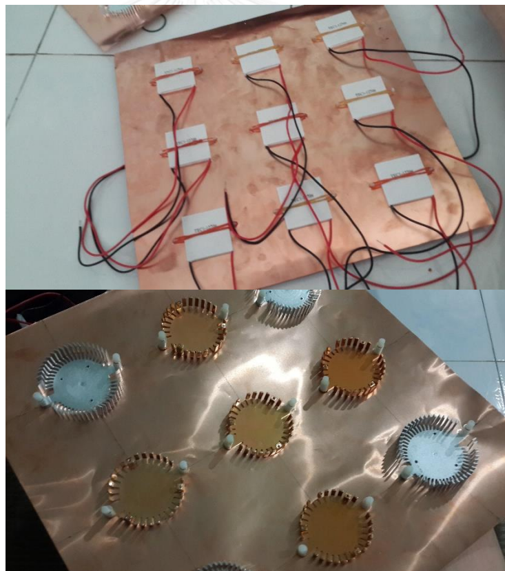
ภาพที่ 21 แสดงการติดตั้งเทอร์โมอิเล็กทริก กับแผ่นทองแดง และAluminum heat sink
