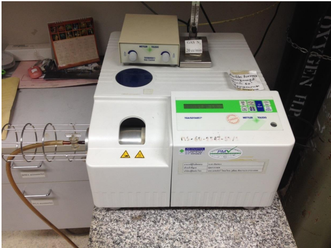
รูปที่ 3.5 เครื่องวิเคราะห์สมบัติทางความร้อน (Thermogravimetric Analysis) ของบริษัท Mettler-Toledo (Thailand), Ltd. รุ่น DSC822 Module
