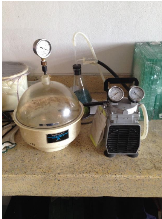
รูปที่ 3.6 หม้อสุญญากาศสำหรับวัดความหนาแน่นตามหลักการแทนที่น้ำ
