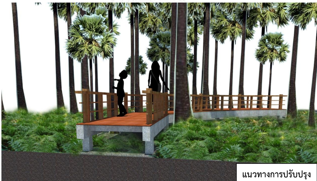
ภาพที่ 5.9 แนวคิดรูปแบบทางเดินที่เสนอ เป็นทางเดินยกระดับโครงสร้าง ค.ส.ล. หรือโครงสร้างไม้ ปูด้วยไม้จริง หรือไม้เทียมตีเว้นร่อง รูปแบบนี้สามารถเพิ่มพื้นที่สัมผัสกับน้ำฝนได้มากขึ้น
