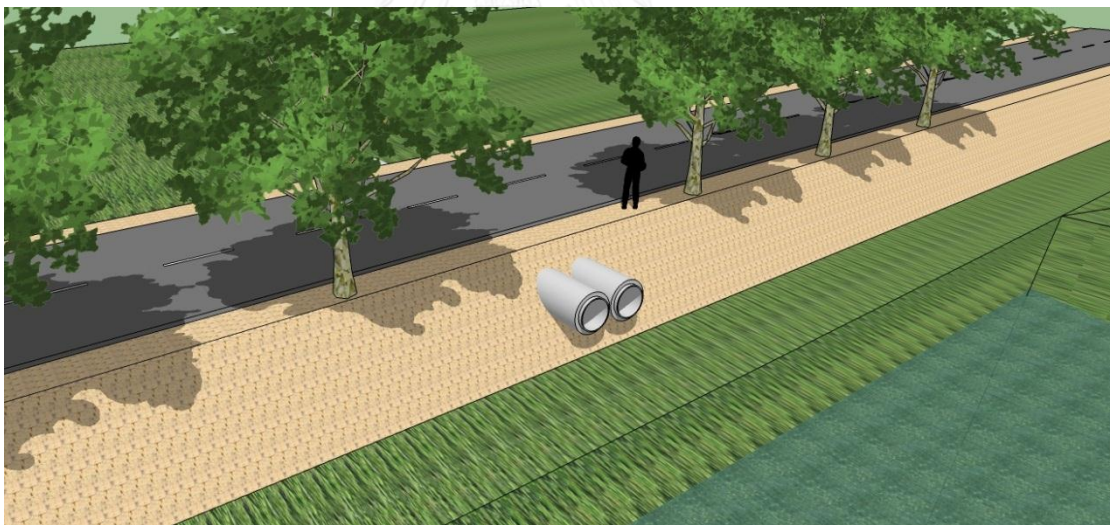
ภาพที่ 5.18 ลักษณะท่อระบายน้ำใต้ดินถนนรอบเกาะคำชะโนดในปัจจุบัน ซึ่งมีขนาดเล็กและมีเพียง 2 จุดเท่านั้น
