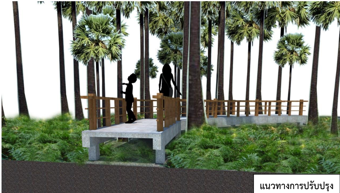
ภาพที่ 5.8 แนวคิดรูปแบบทางเดินที่เสนอ เป็นทางเดินยกระดับโครงสร้าง ค.ส.ล. มีราวกันตกและใช้วัสดุที่กลมกลืนกับลักษณะพื้นที่
