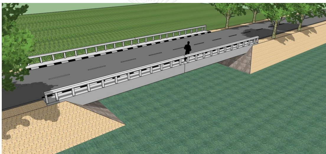
ภาพที่ 5.20 แนวคิดการสร้างสะพานเพิ่ม เพื่อเปิดให้น้ำหลากเข้ามาท่วมบริเวณโดยรอบเกาะคำชะโนดให้มากขึ้น
