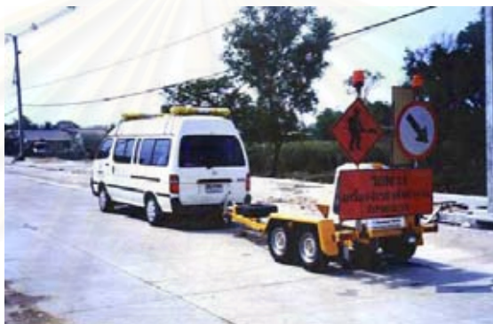
ภาพที่ 2.12 การใช้งานเครื่องมือการตกกระทบของน้ำหนักในสนาม
