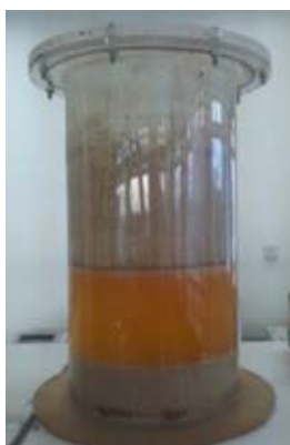
ภาพที่ 3.2 ถังปฏิกรณ์แบบไร้อากาศในห้องปฏิบัติการของหลักสูตร สาขาวิชาวิทยาศาสตร์สิ่งแวดล้อม จุฬาลงกรณ์มหาวิทยาลัย
