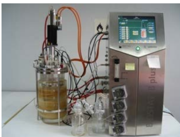
ภาพที่ 2.14 ตัวอย่างเครื่องปฏิกรณ์ชีวภาพแบบถังกวนขนาด 5 ลิตร
