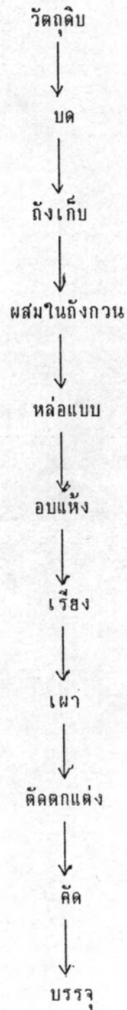
ภาพที่ 2.6 แสดงขั้นตอนการผลิตอิฐทนไฟชนิดฉนวนกันความร้อน (Insulating Brick)
