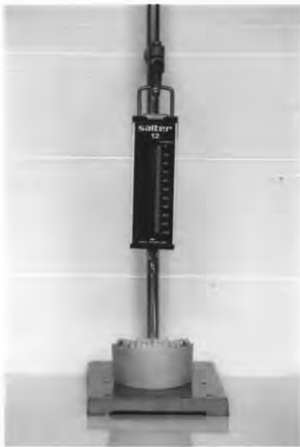
รูปที่ ๔๘ แสดงเครื่องมือเฉพาะกิจที่ใช้ในการตรวจสอบขนาดแรง
