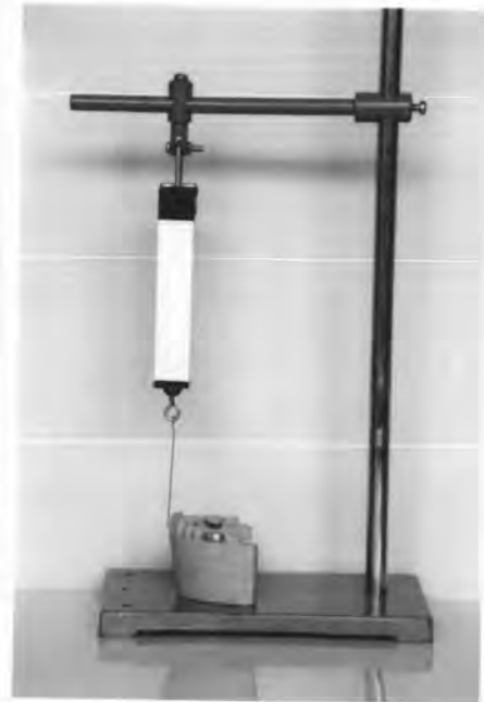
รูปที่ ๔๘ แสดงเครื่องมือเฉพาะกิจที่ใช้ในการตรวจสอบขนาดแรง
