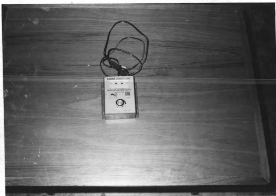
รูป 4.4 รูปถ่ายแสดงรูปร่างของอุปกรณ์ปรับพลังงานไฟฟ้า (Dimmer Control)
