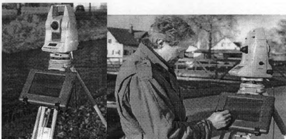
รูปที่ 6.1 การใช้ Penpad Computer ร่วมกับ WILD TC600
