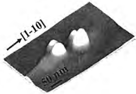
รูปที่ 5.2 ภาพ AFM แบบ 3 มิติของควอนตัมดอทโมเลกุล ชนิด (ก) 2 ดอท (ข) 3 ดอท และ (ค) 4 ดอท
