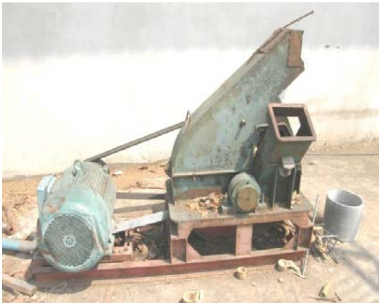
ภาพที่ 3.4 แสดงเครื่องย่อยไม้และเศษไม้ไฟ
