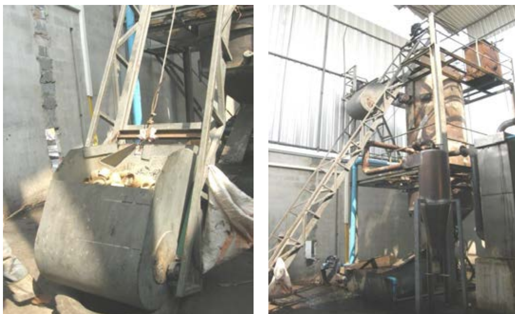
ภาพที่ 3.2 แสดงสายพานลำเลียงวัตถุดิบเข้าสู่เตาเผาเพื่อให้เกิดก๊าซ CO ในการผลิตกระแสไฟฟ้า
