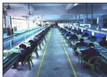
ภาพที่ 2.5 สายการประกอบแบบขนาน (Betancourt, 2007)
