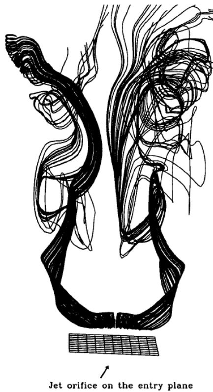
รูปที่ 2.20 วิวัฒนาการของ Streamlines ในการก่อตัวของ Kelvin-Helmholtz roller (Sau et.al. , 2004)
