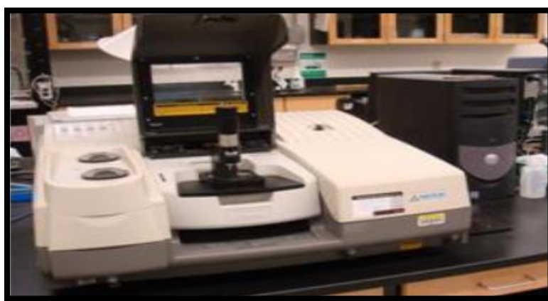
ภาพที่ 3.9 เครื่อง FT-IR Fourier Transform Infrared Spectrophotometer (FT-IR)
