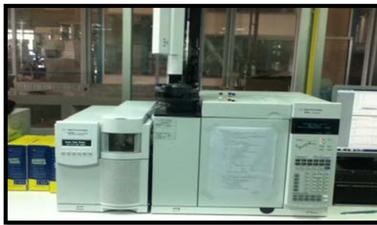
ภาพที่ 3.5 เครื่องแก๊สโครมาโทกราฟีประกอบด้วยแมสสเปกโตรมิเตอร์ (Gas Chromatography – Mass spectrometer, GC-MS)
