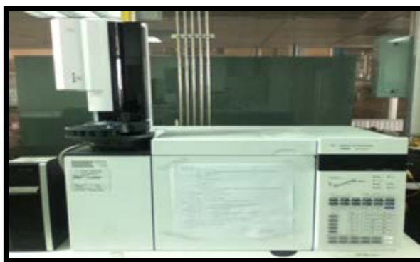
ภาพที่ 3.4 เครื่องแก๊สโครมาโทกราฟีแบบจำลองการกลั่น (Simulated Distillation Gas Chromatography)
