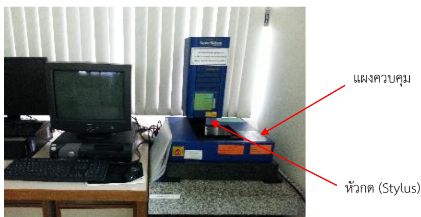
รูปที่ 4.22 เครื่องวัดความหยาบพื้นผิว (Profilometer, Taylor Hobson, Talyscan 150)
