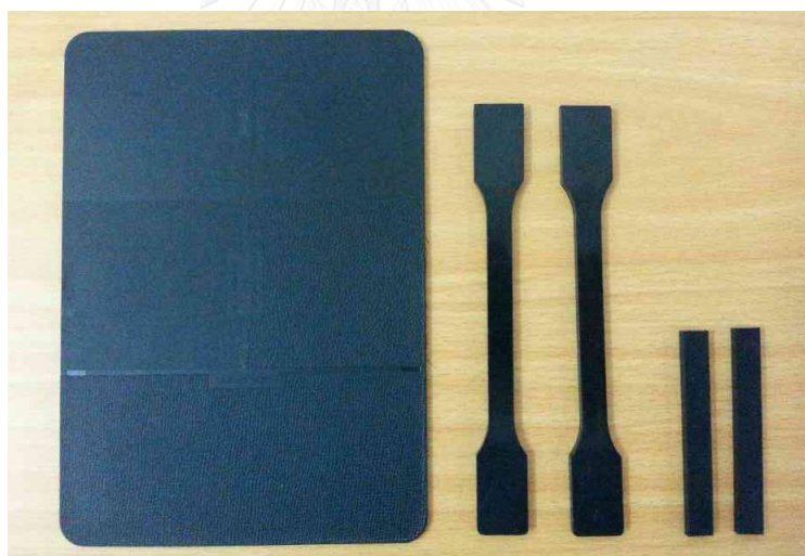
รูปที่ 4.8 ตัวอย่างชิ้นงานสำหรับทดสอบสมบัติด้านทานการขีดข่วน (ซ้าย) สมบัติด้านความทนแรงดึง (กลาง) ความต้านทานแรงดัดโค้งและความทนแรงกระแทก (ขวา)
