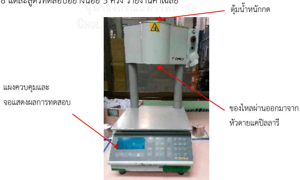
รูปที่ 4.18 เครื่อง Dynisco melt flow index tester
