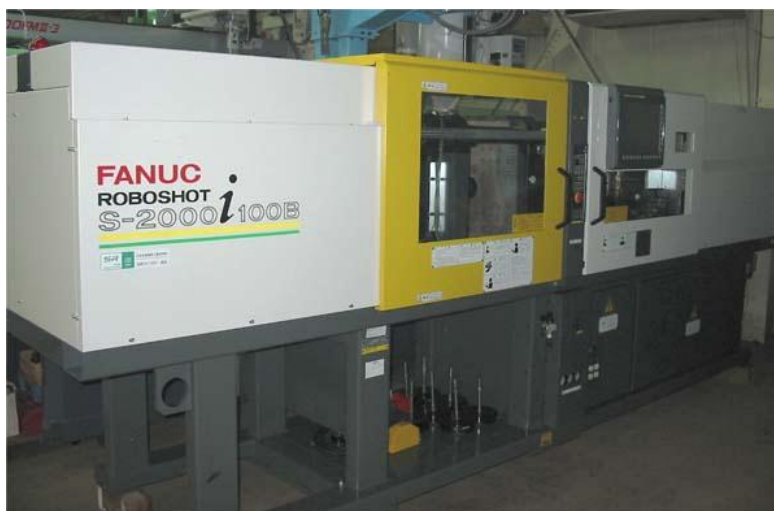
รูปที่ 4.7 เครื่องฉีดขึ้นรูป (Injection molding) (FANUC ROBOSHOT S-2000i100B)
