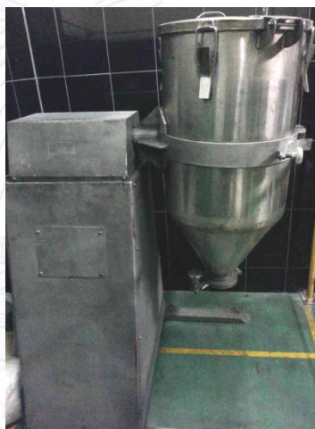
รูปที่ 4.4 เครื่องผสมแบบถังหมุน (Drum tumbler)
