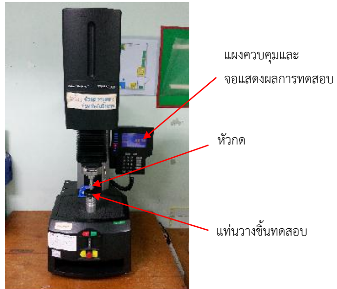
รูปที่ 4.17 เครื่องวัดความแข็งแบบ Rockwell (Wilson Rockwell tester series 2000)
