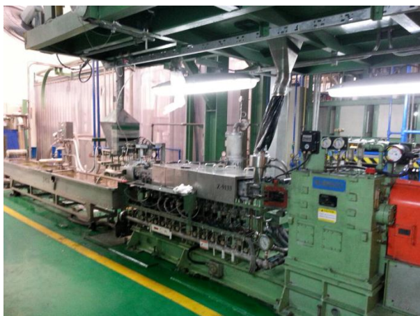
รูปที่ 4.5 เครื่องอัดรีดแบบสกรูคู่ (Twin screw extruder)
