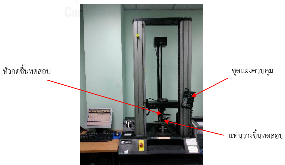
รูปที่ 4.15 เครื่องทดสอบสมบัติด้านการดัดโค้ง (Instron รุ่น 5566)
