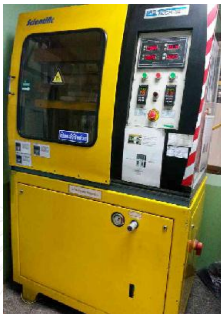
รูปที่ 4.9 เครื่องกดอัด (Hydraulic Press, LabTech/Scientific)
