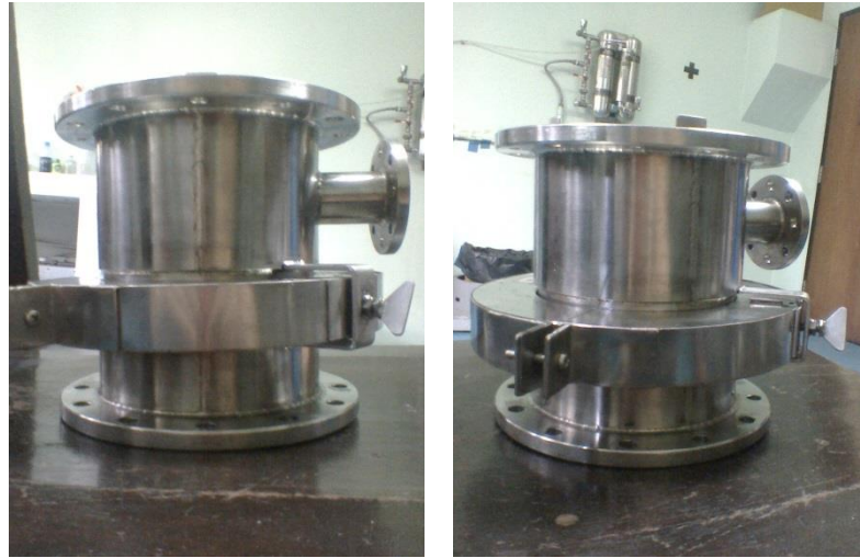
รูปที่ 3.15 ติดตั้งแม่เหล็กเข้ากับกระบอกเรโซแนนซ์
