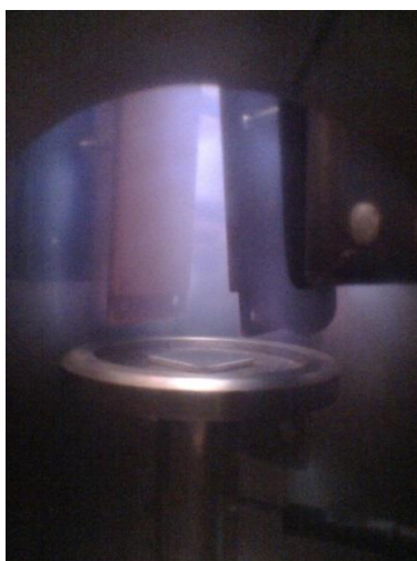
รูปที่ 4.5 พลาสมาที่แรงดันลบ 500 V และไมโครเวฟ 700 W
