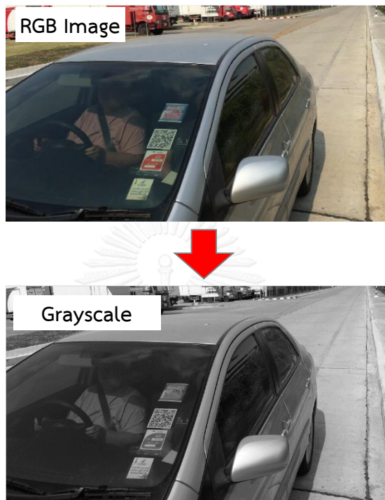
ภาพที่ 28 การแปลงภาพจาก RGB Image เป็น Grayscale Image
