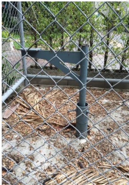
รูปที่ 3.8 ลักษณะหมุดสถานีวัดแผ่นดินทรุด โดยในรูปคือหมุด CI-4 ของ BM.8 สถานีวัดแผ่นดินทรุดที่ 25 สำนัก อนุรักษ์และฟื้นฟูทรัพยากรน้ำบาดาล กรมทรัพยากรน้ำบาดาล โดยมีฐานรากฝังลึกลงไป 197 เมตรจากผิวดิน
