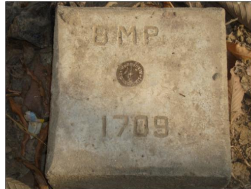
รูปที่ 3.7 ลักษณะหมุดระดับที่มีการฝังไว้บนแท่นคอนกรีตที่พื้น โดยในรูปเป็นหมุด P.1709 อยู่ภายในบริเวณ วัดเพรางาย อ.ไทรน้อย จ.นนทบุรี โดยมีกรมแผนที่ทหารเป็นผู้ดูแล
