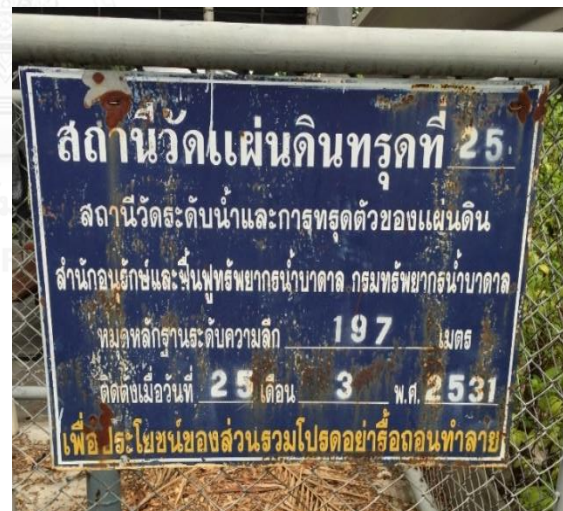
รูปที่ 3.8 ลักษณะหมุดสถานีวัดแผ่นดินทรุด โดยในรูปคือหมุด CI-4 ของ BM.8 สถานีวัดแผ่นดินทรุดที่ 25 สำนัก อนุรักษ์และฟื้นฟูทรัพยากรน้ำบาดาล กรมทรัพยากรน้ำบาดาล โดยมีฐานรากฝังลึกลงไป 197 เมตรจากผิวดิน
