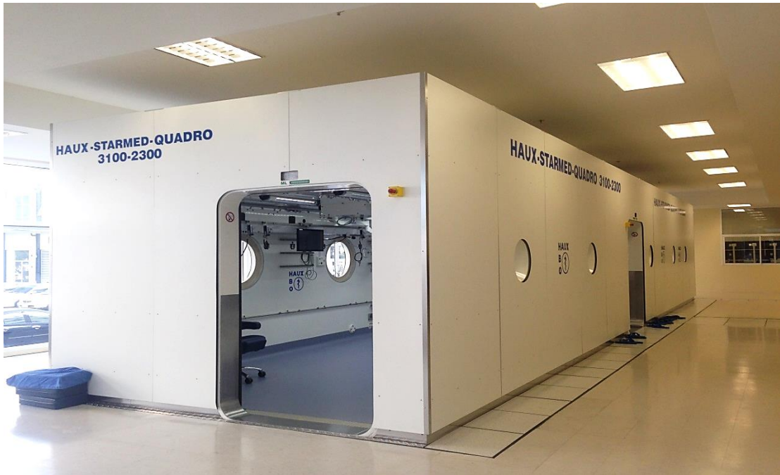
ภาพที่ 7 ห้องปรับแรงดันบรรยากาศสูง ชนิดหลายคน (Multiplace chamber) ขนาด 30 ที่นั่ง (โรงพยาบาลสมเด็จพระปิ่นเกล้า)
