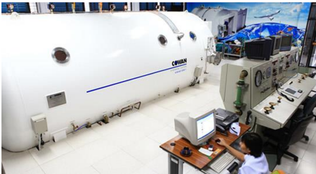
ภาพที่ 5 ห้องปรับแรงดันบรรยากาศสูง ชนิดหลายคน (Multiplace chamber) ขนาด 12 ที่นั่ง (โรงพยาบาลศิริรฎกเกิด)
