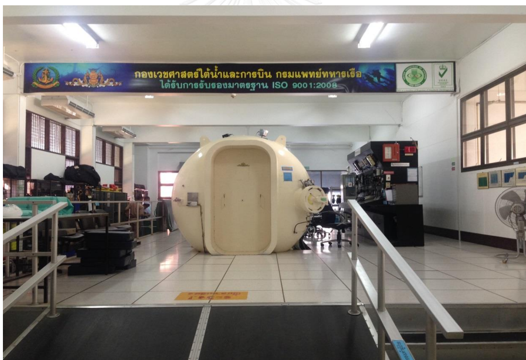
ภาพที่ 4 ห้องปรับแรงดันบรรยากาศสูง ชนิดหลายคน (Multiplace chamber) ขนาด 16 ที่นั่ง (กองเวชศาสตร์ใต้น้ำและการบิน กรมแพทย์ทหารเรือ)
