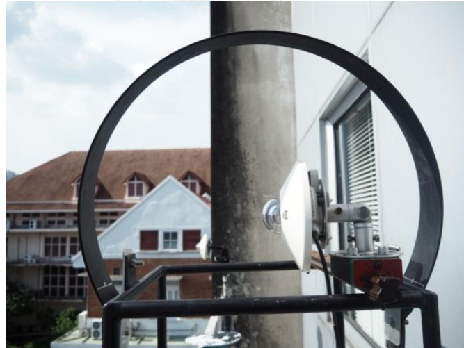
รูปที่ 5.3 การติดตั้ง pyranometer พร้อมแหวนบังเงา
