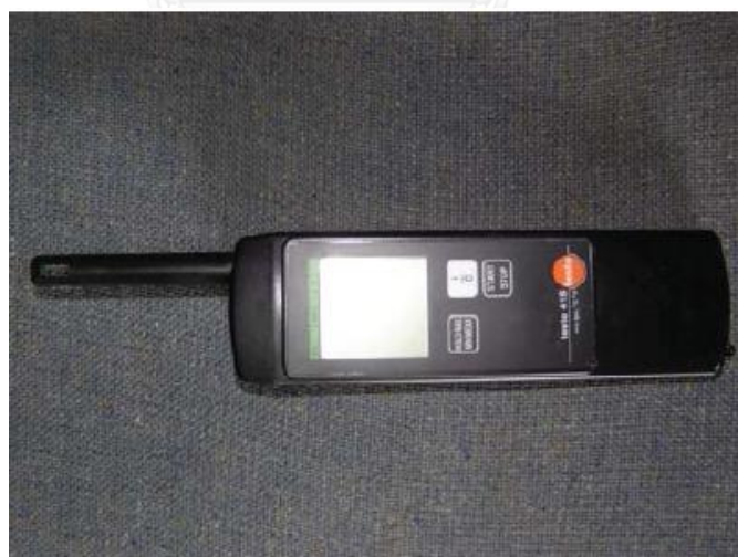
รูปที่ 5.8 เครื่องวัดอุณหภูมิและความเร็วของอากาศแบบมือถือ [23]
