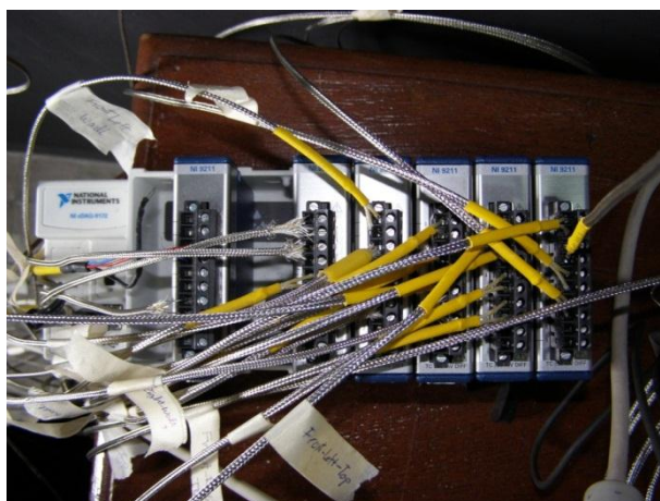
รูปที่ 5.5 แสดงเครื่องจัดเก็บข้อมูล (data logger) [23]
