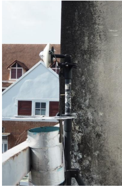
รูปที่ 5.2 การติดตั้ง pyranometer ภายนอกห้อง
