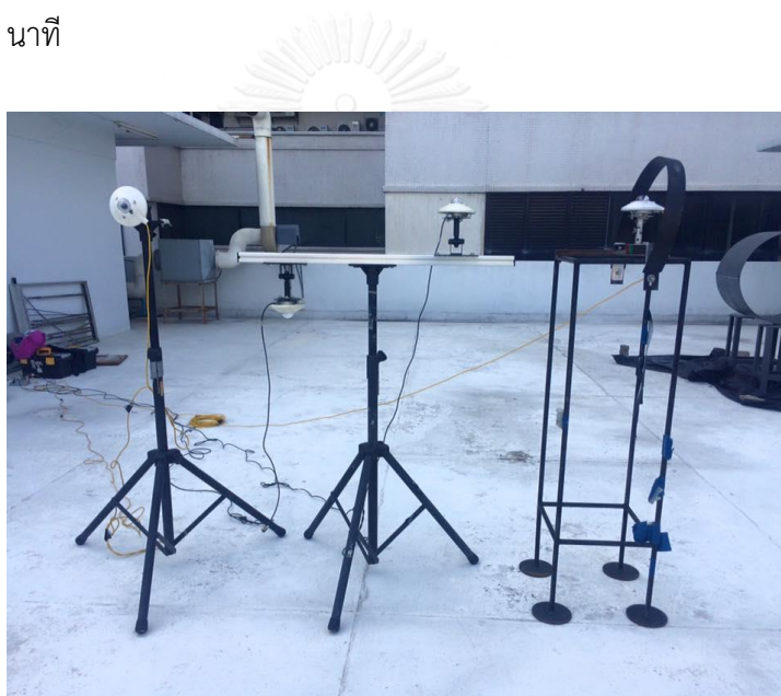
รูปที่ ก.1 การติดตั้งอุปกรณ์เพื่อค่าสัมประสิทธิ์การสะท้อนรังสีแสงอาทิตย์ของพื้นแดดฟ้าของอาคาร โคลัมโบ คณะวิศวกรรมศาสตร์ จุฬาลงกรณ์มหาวิทยาลัย
