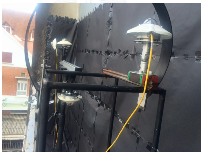
รูปที่ ก.5 การติดตั้งอุปกรณ์เพื่อค่าสัมประสิทธิ์การสะท้อนรังสีแสงอาทิตย์ของพื้นระเบียงห้องทดลองที่ชั้น 4 อาคารฮันส์ บันตลี คณะวิศวกรรมศาสตร์ จุฬาลงกรณ์มหาวิทยาลัย
