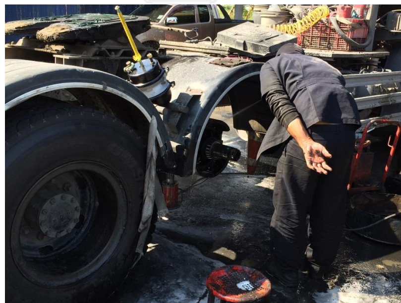
รูปที่ 3.3 งานซ่อมการเปลี่ยนลูกปืนล้อ
