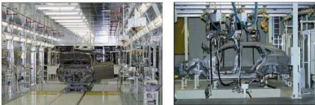
รูปที่ 2.4 สายการประกอบแบบสองด้านในอุตสาหกรรมยานยนต์จริง
