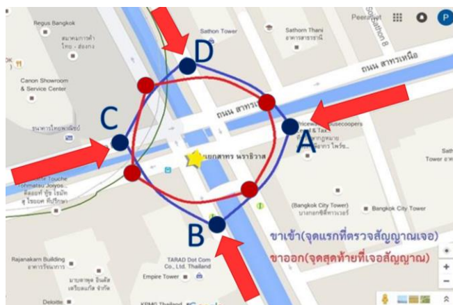
รูปที่ 3.13 ตำแหน่งที่อุปกรณ์ตรวจจับสัญญาณบลูทูธตรวจจับสัญญาณบลูทูธ ที่ทดสอบโดยการเดิน ที่มา : พีร์วัสและภวินท์ (2558)
