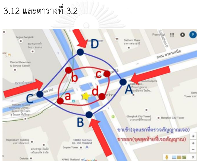
รูปที่ 3.12 ตำแหน่งที่อุปกรณ์ตรวจจับสัญญาณบลูทูธได้ตรวจจับสัญญาณบลูทูธที่อยู่ในยานพาหนะทดสอบ ที่มา : พีรวัสและภวินท์ (2558)
