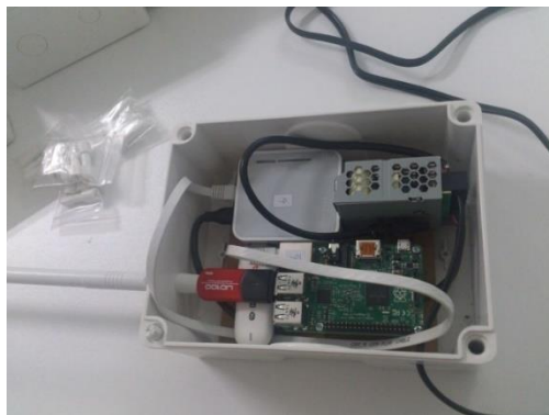
รูปที่ 3.9 ลักษณะภายในของอุปกรณ์ตรวจจับสัญญาณบลูทูธ
