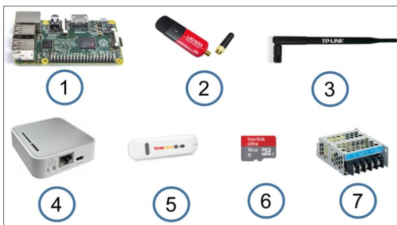
รูปที่ 3.10 ส่วนประกอบของอุปกรณ์ตรวจจับสัญญาณบลูทูธ
