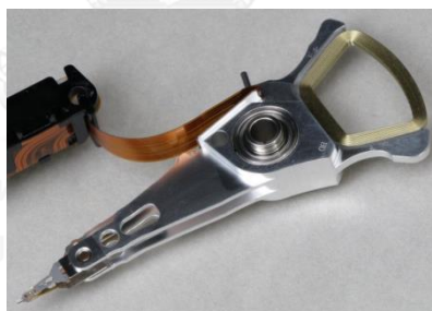
รูปที่ 1.3 ชุดหัวอ่านเขียนที่ประกอบเสร็จสมบูรณ์ (Babin, 2005)
