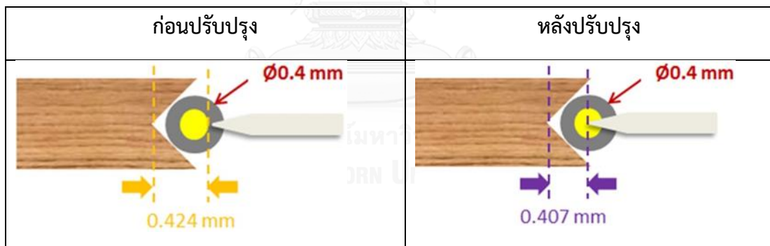
รูปที่ 4.6 ระยะการผ่าลวดก่อนและหลังการปรับปรุง
