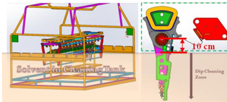
รูปที่ 3.1 กระบวนการล้างแบบจุ่มของหัวอ่านเขียน
