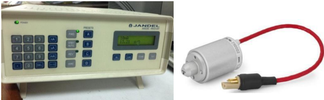
ภาพที่ ง.2 เครื่องวัดค่าการนำไฟฟ้าในแนวแกนด้วยเทคนิค Four point probe
