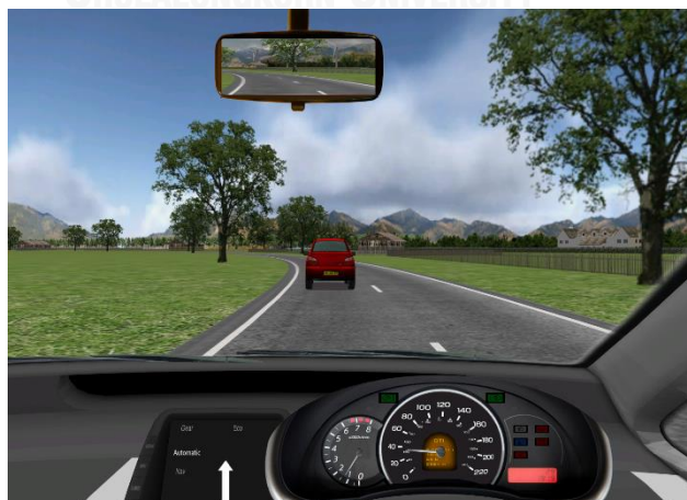
รูปที่ 3-10 หน้าจอแสดงผลกลางของเครื่องจำลองการขับขี่ในสถานการณ์การขับขี่รถยนต์ตามหลังรถยนต์คันด้านหน้า และการควบคุมรถให้อยู่ในช่องทางเดินรถ
