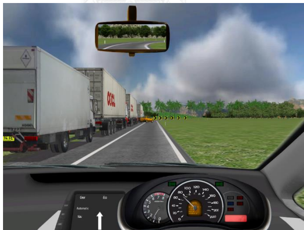
รูปที่ 3-17 หน้าจอแสดงผลกลางของเครื่องจำลองการขับขี่ในขณะที่มีรถยนต์ออกมาตัดหน้า
