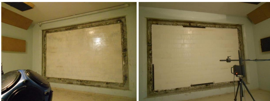
ภาพที่ 2.13 การตรวจสอบเพื่อหาค่าการกั้นเสียงของวัสดุภายในห้องปฏิบัติการ (ที่มา : Façade Testing Institute [FTI]. 2015)
