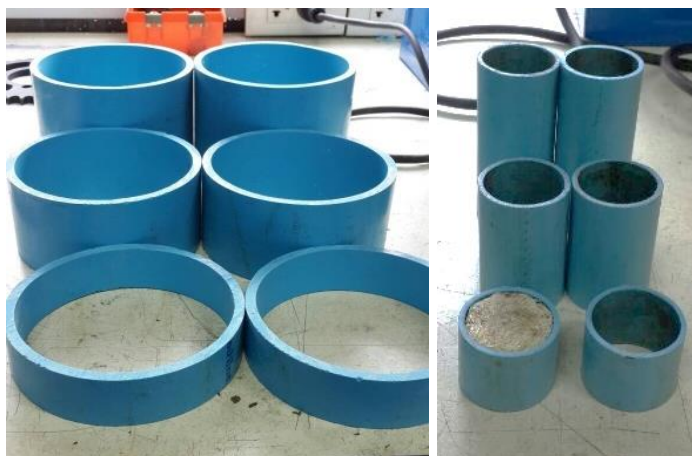
ภาพที่ 3.6 ท่อ PVC ที่ใช้เป็นแม่แบบในการบรรจุวัสดุ
