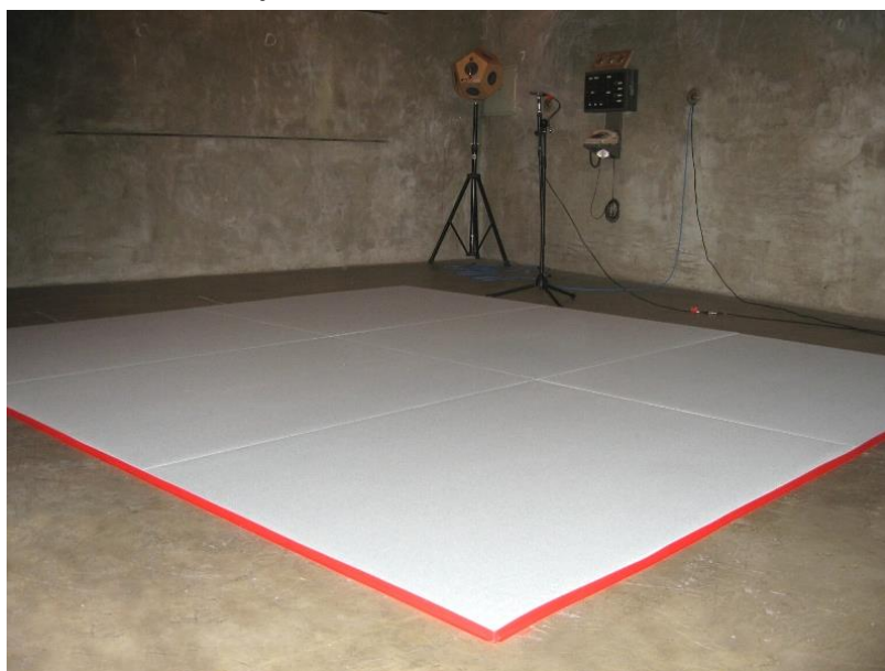
ภาพที่ 2.12 การตรวจสอบเพื่อหาค่าการดูดซับเสียงของวัสดุภายในห้องปฏิบัติการ
