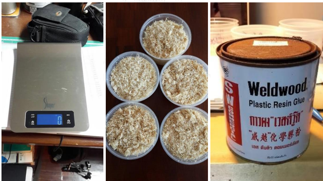
ภาพที่ 3.7 เครื่องชั่งน้ำหนักดิจิทัลยี่ห้อ TANITA (ซ้าย), เส้นใยทุเรียนที่ผสมกับขี้เลื่อยไม้ก่อนใส่สารประสาน (กลาง), กาวผงยี่ห้อ Westwood ที่ใช้เป็นสารประสาน (ขวา)
