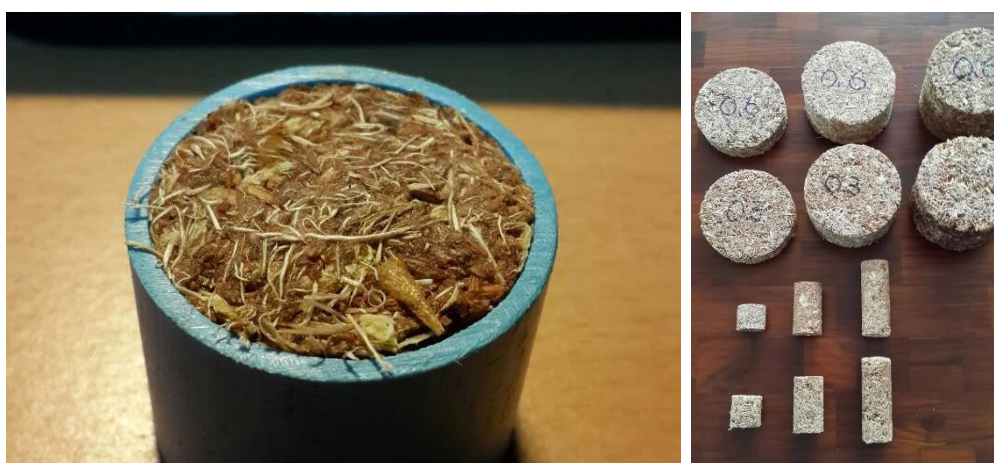
ภาพที่ 3.8 วัสดุเมื่อทำการบรรจุลงในแม่แบบและทำการบีบอัดแล้ว (ซ้าย) ตัวอย่างชิ้นงานที่เสร็จสมบูรณ์หลังจากถอดแม่แบบออก (ขวา)
