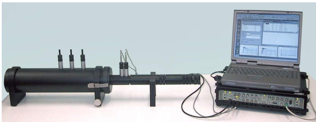
ภาพที่ 3.17 ลักษณะการเชื่อมต่อของอุปกรณ์ที่ใช้ในการตรวจสอบคุณสมบัติทางเสียง (ที่มา : http://www.bksv.com/ )
