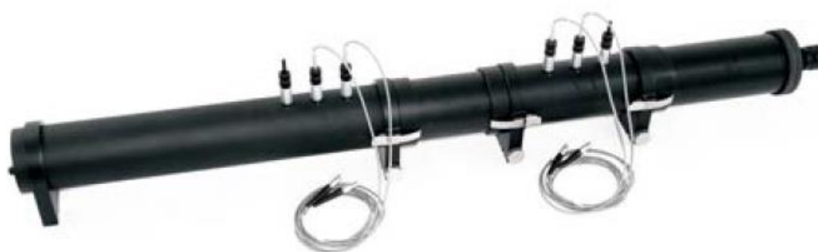
ภาพที่ 3.11 ลักษณะของ Impedance Tube B&K 4206 และ Transmission Loss Tube UA-1630 สำหรับตรวจวัดชิ้นงานขนาด 100 mm (ที่มา : http://www.bksv.com/ )
