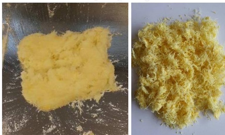
ภาพที่ 3.5 เยื่อทุเรียนหลังผ่านการต้มด้วยสารละลาย H_2O_2 (ซ้าย)
