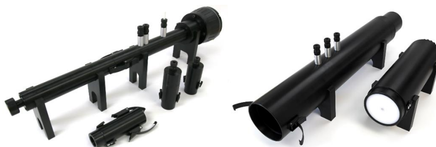
ภาพที่ 2.16 ลักษณะของท่อความต้านทาน (ที่มา : http://www.bksv.com/ )
