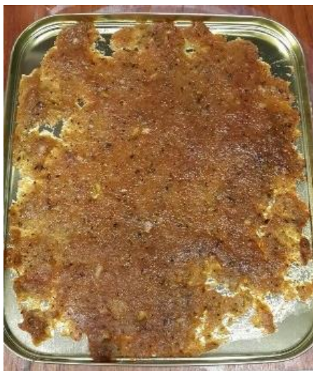
ภาพที่ 3.4 เยื่อทุเรียนหลังผ่านการต้มด้วยสารละลาย NaOH
