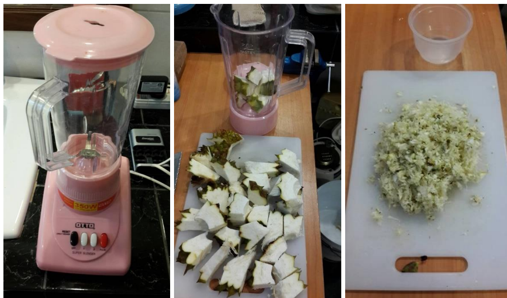
ภาพที่ 3.2 เครื่องปั่นน้ำผลไม้ยี่ห้อ OTTO และของเปลือกทุเรียนที่หั่นจนได้ขนาด 2 cm ก่อนและหลังเข้าเครื่องปั่นน้ำผลไม้
