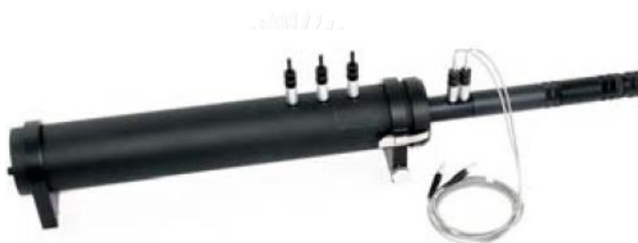
ภาพที่ 3.9 ลักษณะของ Impedance Tube B&K 4206 สำหรับตรวจวัดชิ้นงานขนาด 100 mm (ที่มา : http://www.bksv.com/ )
