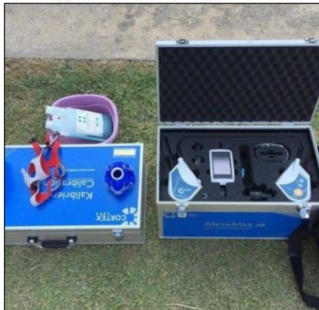
รูปที่ 14 แสดงเครื่องวัดอัตราการแลกเปลี่ยนแก๊ส (Metamax 3B)
