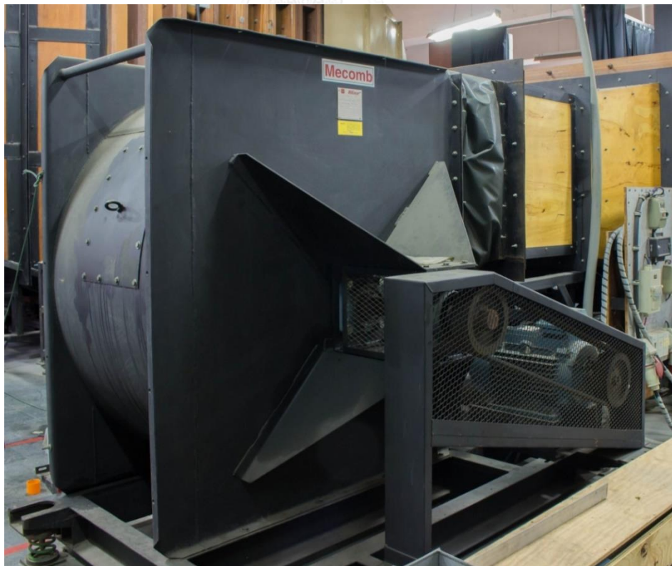
รูปที่ 4.4 Centrifugal blower สำหรับอุโมงค์ลมเพื่อสร้างกระแสลมขวาง
