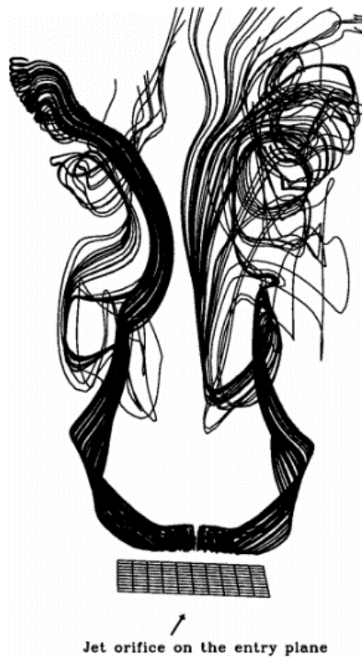
รูปที่ 2.9 วิวัฒนาการของ Streamlines ในการก่อตัวของ Kelvin-Helmholtz roller (Sau et al., 2004)
