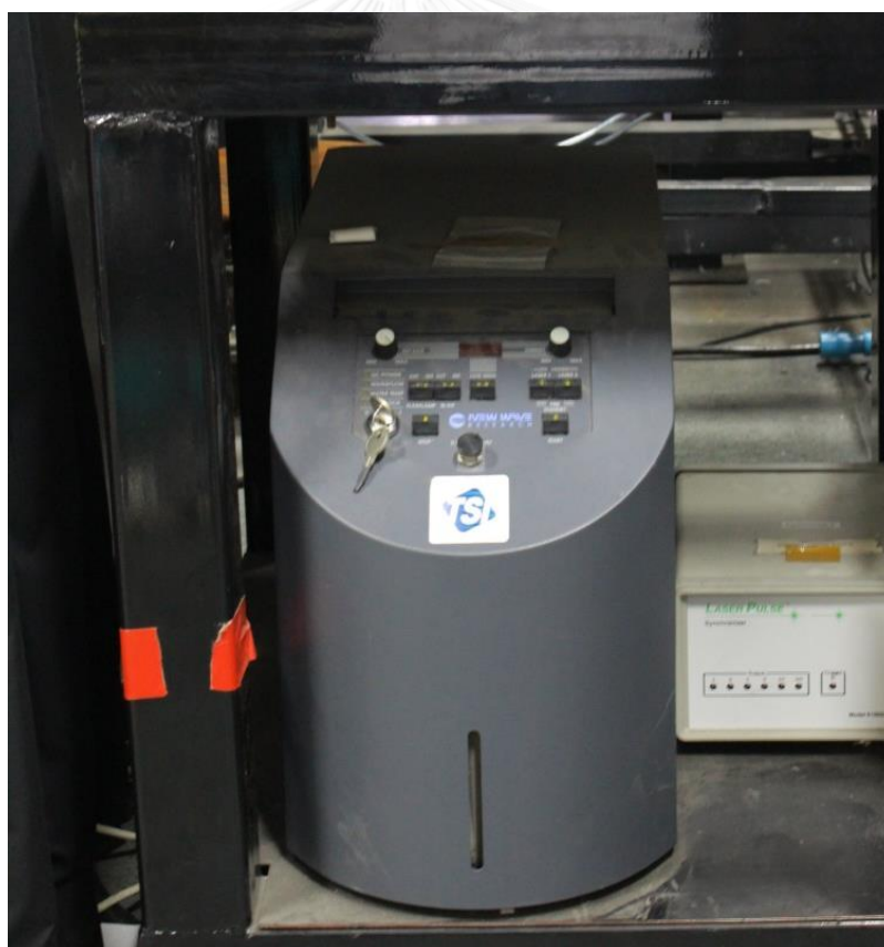
รูปที่ 4.11 เครื่องกำเนิดแสงเลเซอร์ ND:YAG ยี่ห้อ New Wave™ model Solo 200XT
