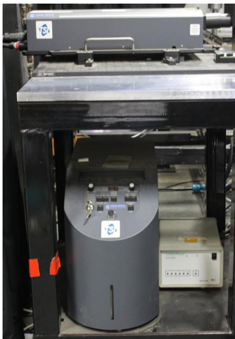
รูปที่ 4.5 เครื่องกำเนิดแสงเลเซอร์ ND:YAG ยี่ห้อ New Wave Research™ model Solo 200XT กำลังสูงสุด 200 mJ/pulse ที่ความยาวคลื่น 532 nm
