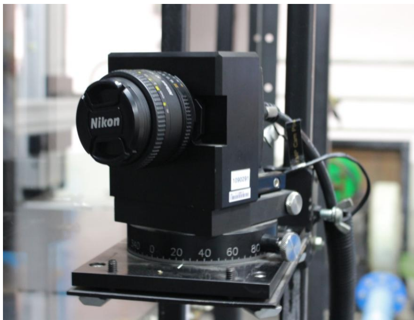
รูปที่ 4.7 กล้อง CCD ยี่ห้อ PowerView Plus11MP model 630062 ความละเอียด 4008 × 2672 pixel 2 ขนาดpixel 9 × 9 \mu\text{m}^2 , ขนาด CCD 36.07 × 24.05 mm 2 , และไดนามิกเรนจ์ 12 bit
