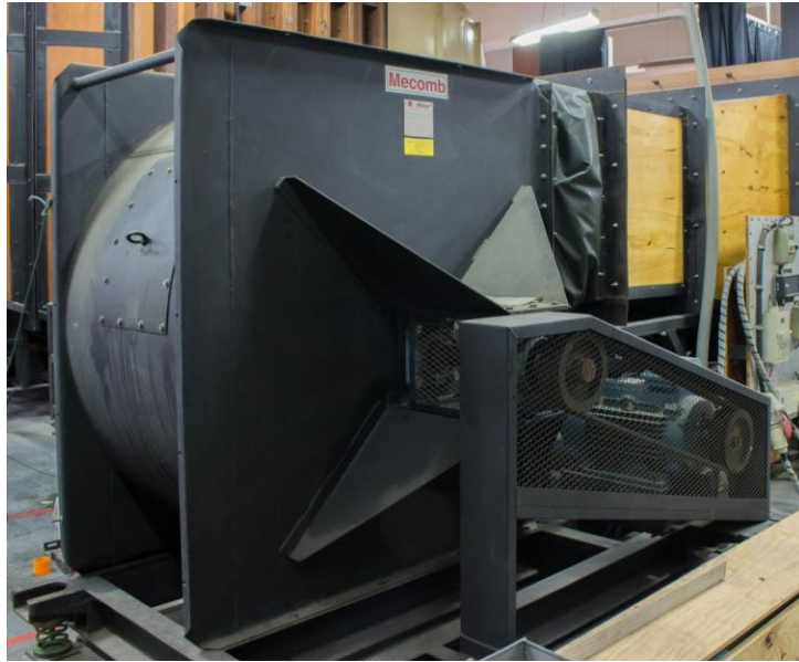
รูปที่ 4.3 พัดลมหอยโขงขนาด 15 กิโลวัตต์ (centrifugal blower ประเภท backward curve airfoil blades)
