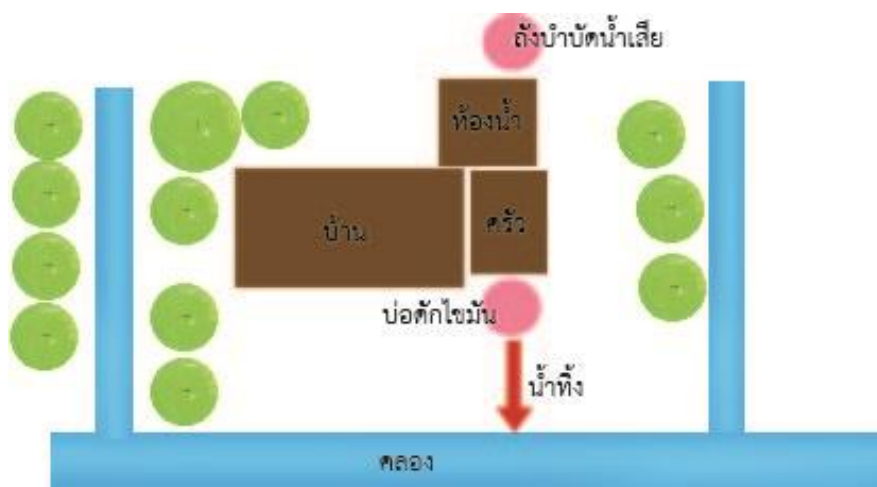
รูปที่ 44 แนวคิดการติดตั้งบ่อดักไขมันและถังบำบัดน้ำเสียก่อนปล่อยลงสู่คลอง ที่มา: ปรับปรุงจากเอกสารประกอบการประชุมผังเมืองรวมอัมพวา โดยคณะสถาปัตยกรรมศาสตร์ จุฬาลงกรณ์มหาวิทยาลัย
