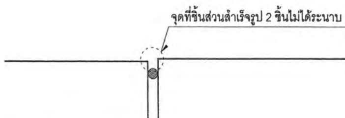
รูปภาพ 6.9 แสดงลักษณะความคลาดเคลื่อนของชั้นส่วนผนังสำเร็จรูปที่ต้องระวังในขั้นตอนของการติดตั้ง
