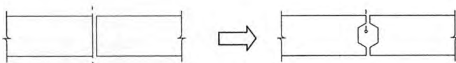
รูปภาพ 6.10 แสดงลักษณะของชั้นส่วนผนังสำเร็จรูปที่มีส่วนเว้าเพื่อกันการไหลย้อนของน้ำ
