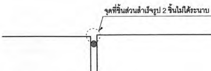
รูปภาพ 6.6 แสดงชิ้นส่วนผนังสำเร็จ 2 ชั้น ที่มีความคลาดเคลื่อนตามแกนแนวขวางจากการติดตั้งซึ่งส่งผลให้ผนังไม่ได้แนวระนาบกัน
