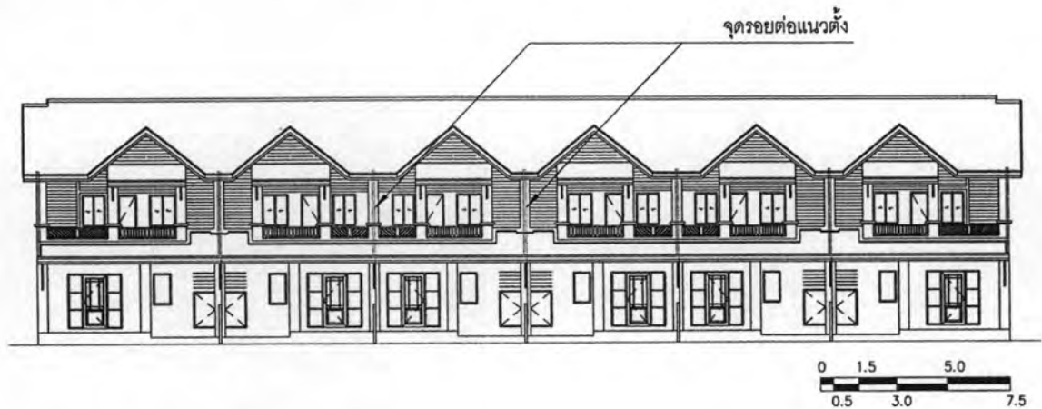
รูปภาพ 5.34 แสดงรูปด้านหน้าแสดงตำแหน่งรอยต่อเปียก (Wet joints) แนวแกนตั้งต่อ 1 บล็อก อาคาร
