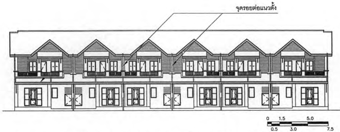
รูปภาพ 5.15 แสดงรูปด้านหน้าแสดงตำแหน่งรอยต่อแบบแห้ง (Dry joints) แนวแกนตั้งต่อ 1 บล็อก อาคาร
