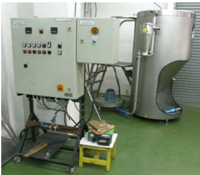
ภาพที่ 3-ก เครื่องทำแห้งแบบพ่นฝอย (spray dryer)
