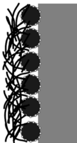
รูปที่ 2.13 ชั้นตัวเร่งปฏิกิริยาในเซลล์เชื้อเพลิงพีอีเอ็ม [1]
