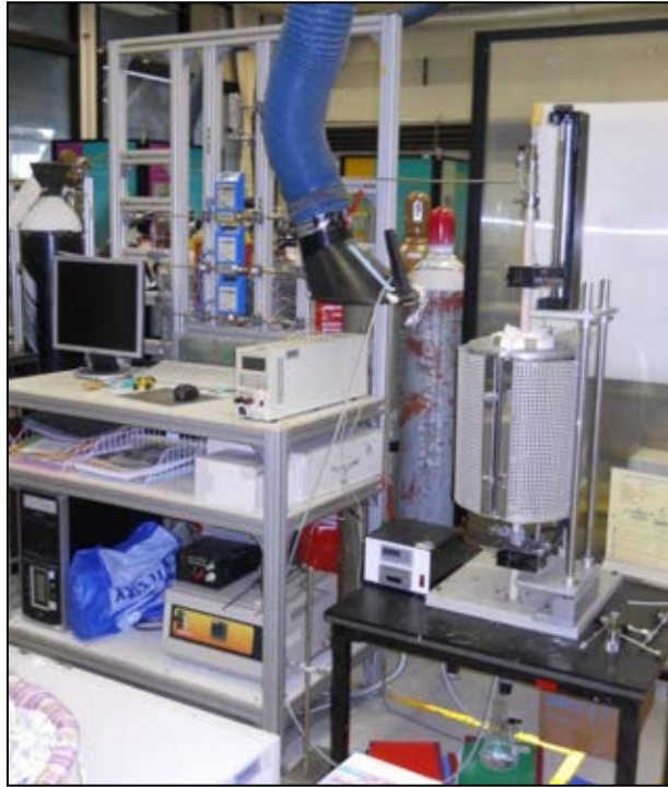
ภาพที่ 3.5 เครื่องทดสอบประสิทธิภาพของเซลล์เชื้อเพลิงชนิดเซลล์เดี่ยว (fuel cell test station)
