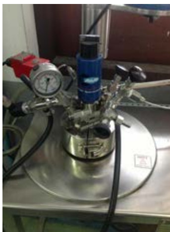
รูปที่ 3.1 ชุดอุปกรณ์สำหรับทำปฏิกิริยาไฮโดรจีโนไลซิส
