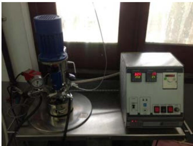
รูปที่ 3.13 การตั้งเครื่องมือในการทำปฏิกิริยาไฮโดรจีนในไลซิส
