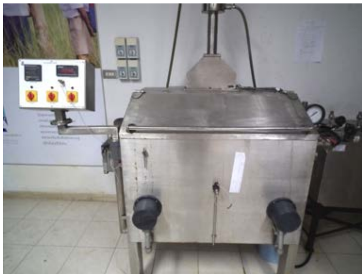
ภาพที่ 3-1 เครื่องต้มเยื่อ (autoclave digester)
