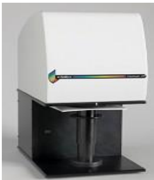
ภาพที่ 3-9 เครื่องวัดสมบัติเชิงแสงของแผ่นทดสอบ (Color Touch PC)
