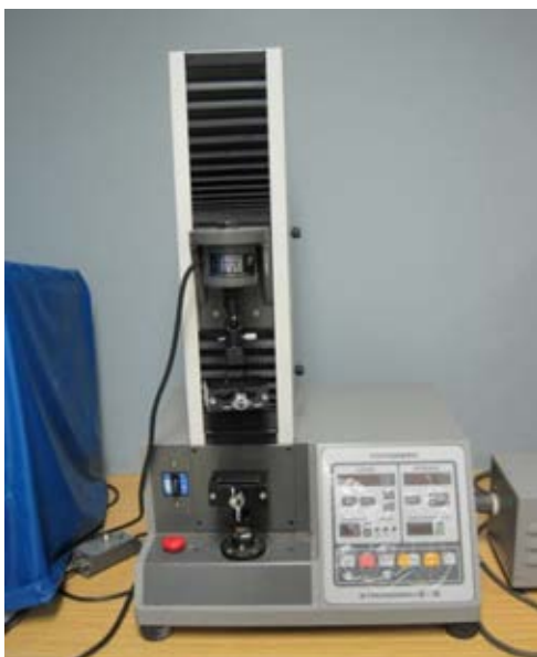
ภาพที่ 3-10 เครื่องวัดความแข็งแรงต่อแรงดึง
