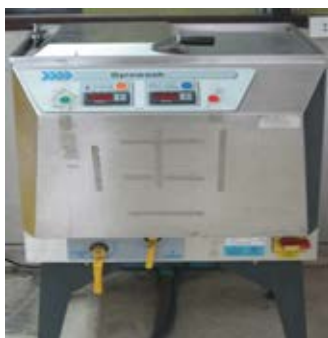
ภาพที่ 3.4 เครื่องทดสอบการซัก Gyrowash
