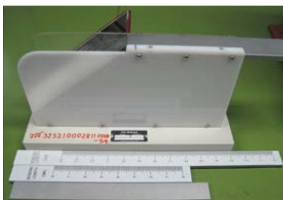
ภาพที่ 3.9 เครื่องทดสอบความแข็งกระด้างของผ้า
