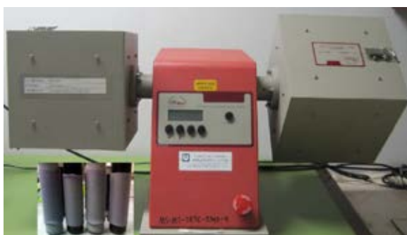
ภาพที่ 3.2 เครื่อง ICI pilling box เตรียมผ้าขึ้นขน
