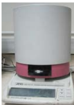
ภาพที่ 3.11 เครื่องชั่งน้ำหนักระบบอินฟราเรด
