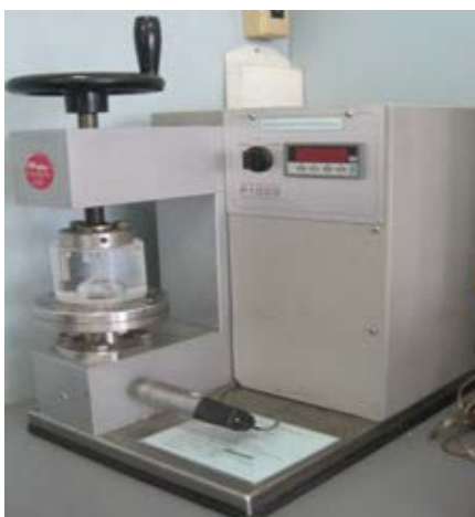
ภาพที่ 3.8 เครื่องทดสอบความแข็งแรงของผ้าด้านความต้านแรงดันทะลุ
