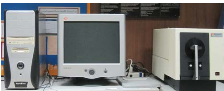
ภาพที่ 3.5 เครื่องวัดสี reflectance spectrophotometer (Macbeth Color-Eye 7000)
